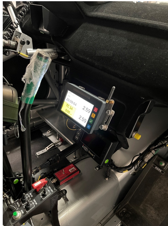
Foto 9. DISPOSITIVO INSTALADO EN LA ZONA CENTRAL DEL VEHÍCULO DE COMPETICIÓN
